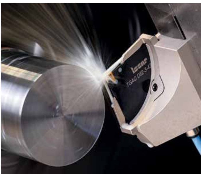
JETCROWN maximerar produktiviteten vid avstickning genom att tillföra högtryckskylvätska med exakt precision.
