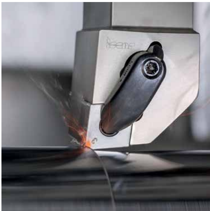
Svarvning istället för slipning: finsvarvning av detalj i härdat stål med hjälp av ett skär med PCBN-spets.
