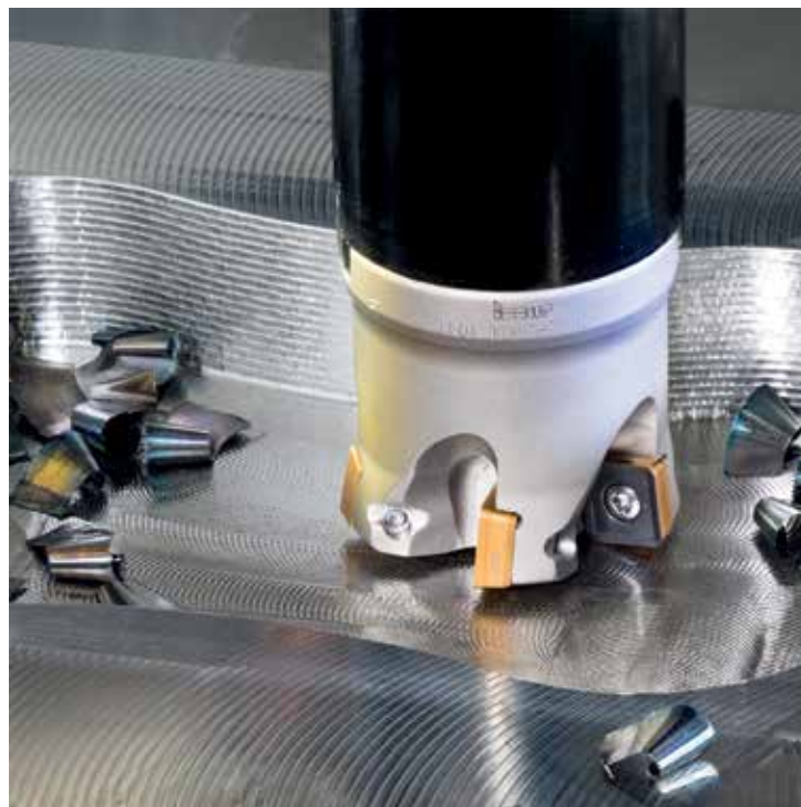
Högmatningsfräsning är fortfarande en effektiv metod för grovbearbetning av såväl plana som komplexa ytor.
