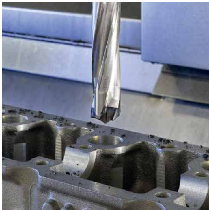
ISCARs borrar med utbytbara spetsar med tre skär ökar produktiviteten och minskar tiden vid skärbyte avsevärt.
